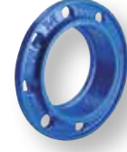
05 Serisi uPVC, çelik ya da düktül font borular için Kilitsiz Sfero dökme demir DN 400-600 (uPVC ve düktül font) DN 50-300 (çelik) PN 10/16
