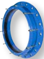
260 Serisi Kaplin ve flanş adaptörü Asbest, çelik, döküm ya da düktül font boru için Çelik DN 350-2000 PN 10/16/25
