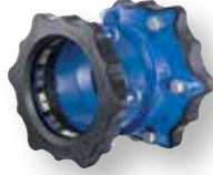
632 Serisi Supa Maxi™ redüksiyonlu kaplin Üniversal ve kilittli Tüm borular için Sfero dökme demir DN 50-300 PN 16
