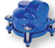
624/10 Serisi Supa Plus™ kör tapa PE ve uPVC Borular için, kilittli Sfero dökme demir DN 40-300 PN 16
