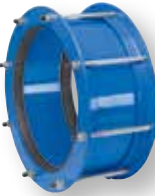
258 Serisi Kaplin Asbest, çelik, döküm ya da düktül font boru için Çelik DN 350-2000 PN 8 to 25
