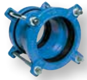
602 Serisi Supa® redüksiyonlu kaplin uPVC, asbest, çelik, döküm ve düktil font borular için Sfero dökme demir DN 40-400 PN 16
