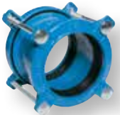
601 Serisi Supa® kaplin uPVC, asbest, çelik, döküm ve düktil font borular için Sfero dökme demir DN 40-400 PN 16
