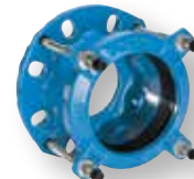
603 Serisi Supa® flanş adaptörü uPVC, asbest, çelik, döküm ve düktil font borular için Üniversal flanş deliği Sfero dökme demir DN 40-400 PN 10/16
