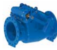
41/36 Serisi Çalpara çekvalf Metal Yataklı Kapalı burç DN350-600 PN10 /16 Sfero dökme demir
