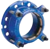
623/10 Serisi Supa Plus™ kilitli flanş adaptörü PE ve uPVC borular için DN40-300 PN10/16 Sfero dökme demir
