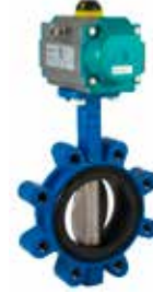
820/10 Serisi Kelebek vana Eş merkezli, Değiştirilebilir yataklı Lug tipi DN25-600 PN10/16 Sfero dökme demir
