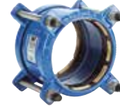
621/10 Serisi Supa Plus™ kilitli kaplin PE ve uPVC borular için DN32-300 PN16 Sfero dökme demir
