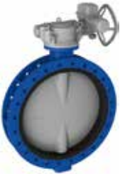
820/20 Serisi Kelebek vana Eş merkezli, Değiştirilebilir yataklı Çift flanşlı tip DN150-1600 PN10/16 Sfero dökme demir
