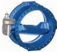
756/102 Serisi Kelebek vana Çift eksantrik Çift flanşlı Paslanmaz çelik gövde siti ISO girişli dişli kutusu DN150-2800 PN10/16 Sfero dökme demir
