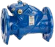
41/60 Serisi Çalpara çekvalf Elastomer siltli Açık burç DN50-300 PN10/16 Sfero dökme demir
