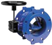
756/100 Serisi Kelebek vana Çift eksantrik Çift flanşlı Yekpare gövde siti IP 67 dişli kutusu DN150-2800 PN10/16 Sfero dökme demir
